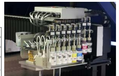
931DSはCMYK + WWWWWの8ヘッド プリントヘッド: Spectra NOVA AAA
